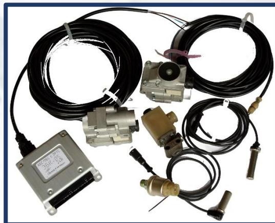
**ЭПМ-2** модулятор электропневматический предназначен для регулирования давления в тормозных камерах согласно электрических команд управления с электронного блока. Обеспечивает управление давлением в исполнительных пневмоцилиндрах по трехфазному алгоритму (подъем, выдержка и сброс).
