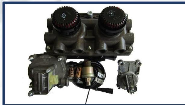
**ДДЭИ** датчик давления электронный интеллектуальный предназначен для получения информации о давлении в пневмобаллонах или пневмосети ТС и передачи ее приемнику цифрового сигнала по CAN сети в соответствии с коммуникационным стандартом J1939.
