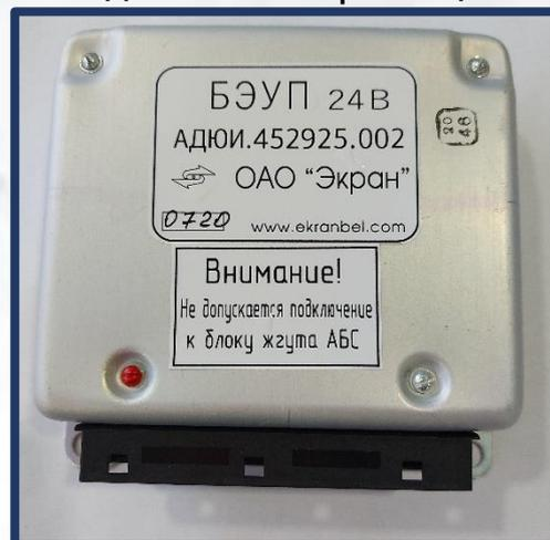
Блок осуществляет управление работой сигнальных лампочек типа А24-2 (ГОСТ 2023.1-88), загорающих при появлении ошибок и выводе блинк-кодов.
