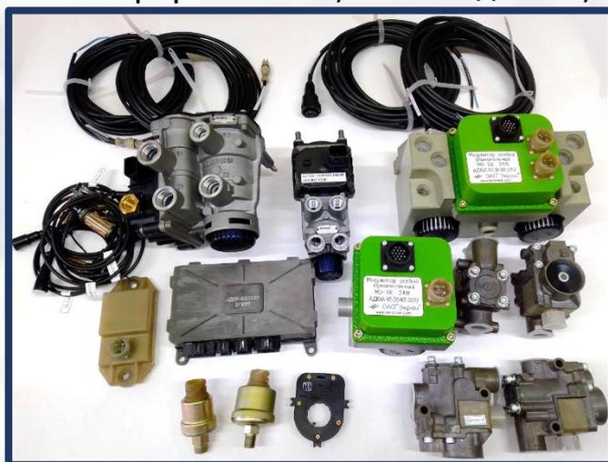
**ДЧВК** предназначен для получения информации о частоте вращения, биения зубчатого ротора и передачи этой информации электронному блоку управления.
